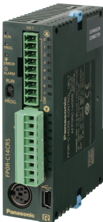
▲ Die neue Steuerungsserie FP0R zeichnet Betriebsdaten auf und kommuniziert mit Datenerfassungssystemen
